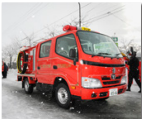
4分団2部（岡）の小型動力ポンプ付積載車。小型動力ポンプを積載したまま放水することができます
