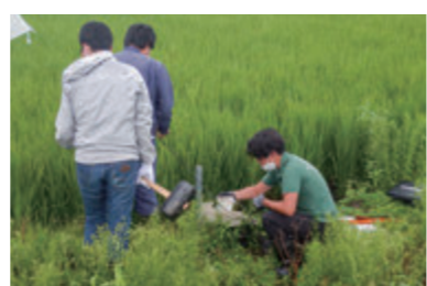
田んぼダムの効果検証のため水位計を設置
